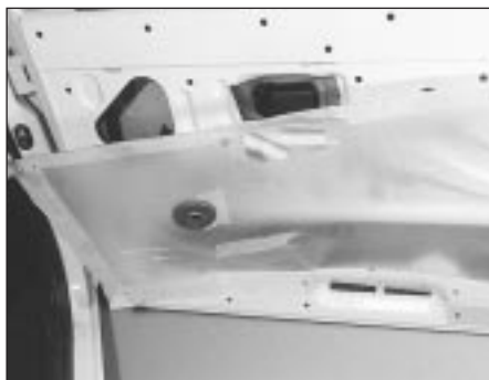
14.38 Peeling back the door waterproof sheet
